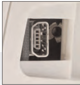
Ci-dessus: Détail du connecteur USB
