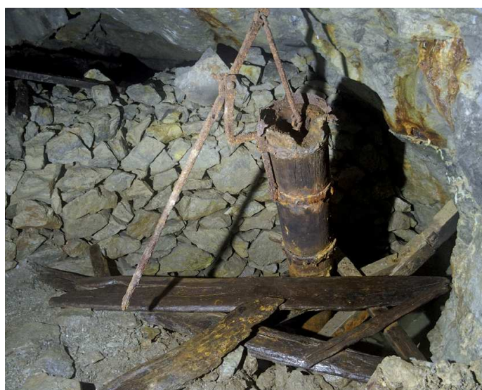
FIG. 29. Pompe manuelle en bois datée du XIX e siècle découverte dans la mine de Vallauria (Tende, Alpes-Maritimes). Cliché B. Ancel.
