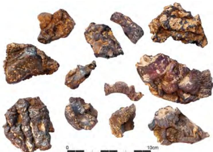
Fig. 148 – SILLANS-LA-CASCADE, Le Grand Défens. Exemples de scories de coulées denses typiques de la réduction indirecte en bas fourneau (cliché D. Dubesset).
