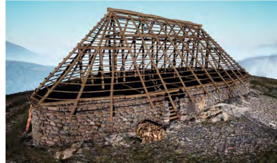
Fig. 54 – ROUBION, Cime de la Tournerie. Restitution des charpentes du bâtiment correspondant au premier état de construction (fin V<sup>e</sup>/début IV<sup>e</sup> siècle, datation provisoire à préciser) (M. Mondou).
