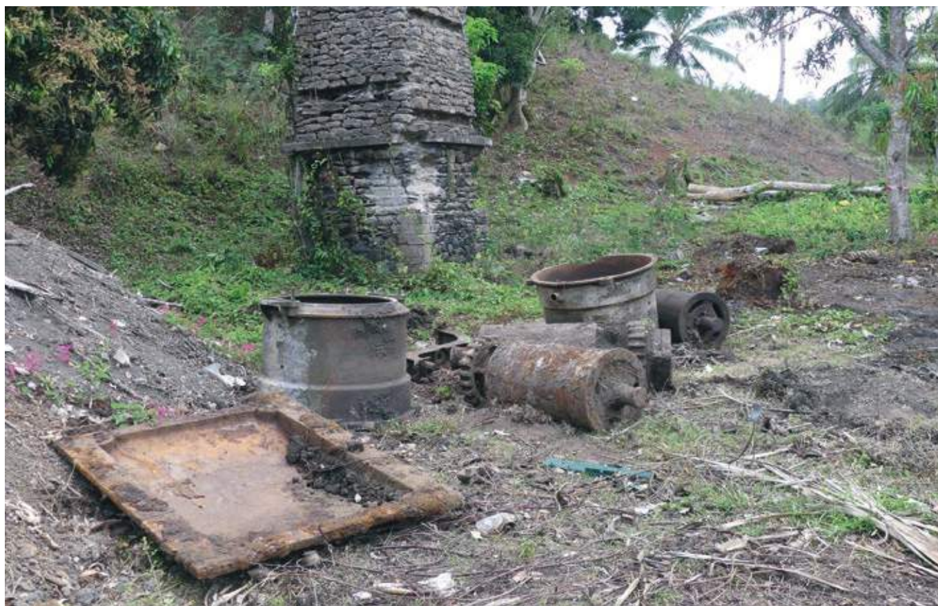
[Fig. 7]: Quelques-unes des pièces de machines industrielles conservées (sommier de filtre-press, cuves de turbines hydro-extractrice et moulin à rolls complet). Celle-ci seront exposées au pied de la cheminée de Longoni (photo M.-H. Jamois / Inrap)
