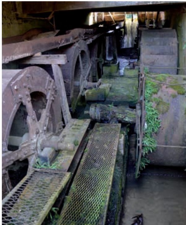
Saint-Étienne-sur-Chalaronne, moulin à farine, double rangée de roues actionnant les deux moulins.
