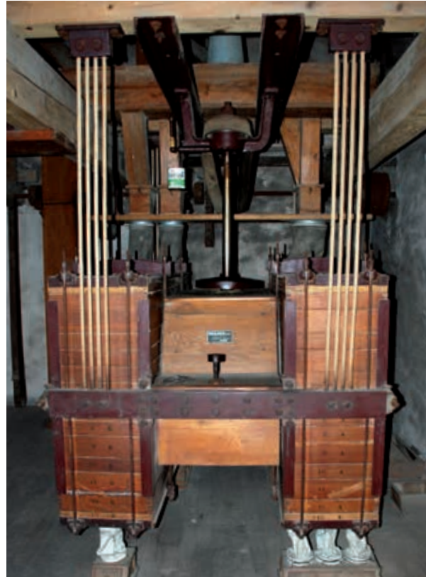
Cerdon, moulin à farine, planschister.
