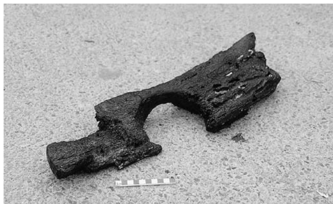
Fig. 12. Arzon, épave Kerjouanno. Pièce aménagée pour le passage d'un amarrage (cl. M.-P. Brin).
