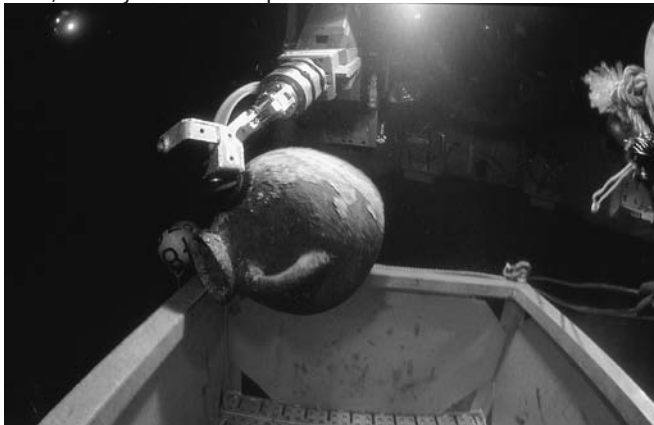
Fig. 44. Hyères, Grand-Ribaud F. Récupération d'une amphore grâce à la ventouse fixée sur le bras du Rémora 2000. Ce système permet de saisir, déplacer et poser délicatement les objets dans le panier (cl. F. Bassemayousse/Photocéans).
