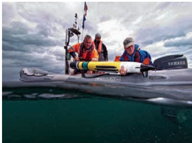
Fig. 2. Récupération de l'AUV de Type Remus 100, en Baie de Seine (cl. T. Seguin/Drassm).
