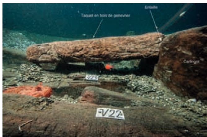
Fig. 121. Renfort des carlingots au moyen de taquets en bois de genévrier - module d'élasticité élevé - (cl. C. Gerigk).
