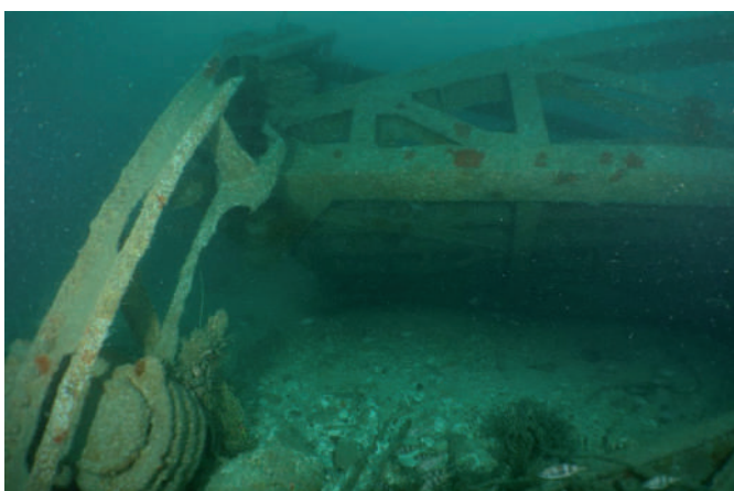
Fig. 6 a et b. Le portique est affaissé sur l'arrière du tablier. Les trépieds de support sont dans l'axe du navire et la poutrelle supérieure en travers, tordue sur le tablier (cl. F. Mathieu).
