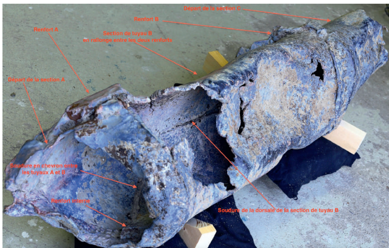
Fig. 72. Vue explicative soulignant les détails de soudure sur la partie prélevée de RD8 (cl. © L. Long).
